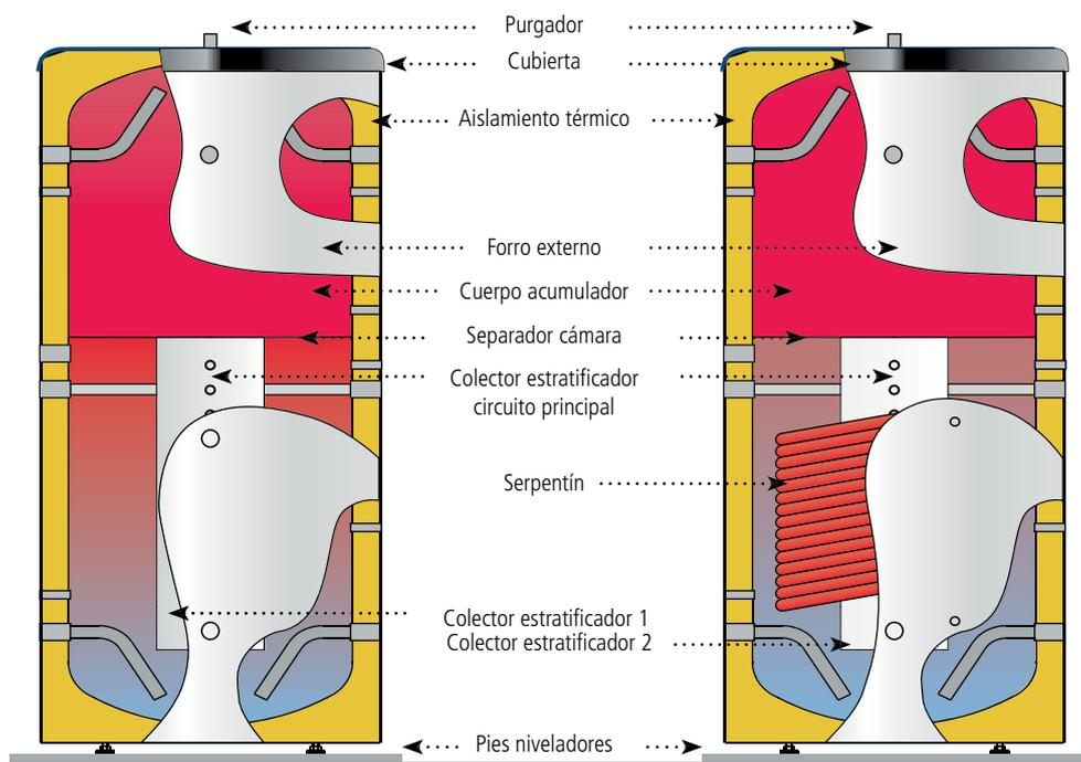
**DEPÓSITOS DE ACUMULACIÓN EN CIRCUITO PRIMARIO:** Depósitos de acumulación energética desde **800 hasta 5.000** litros de capacidad, para circuitos cerrados de calefacción, con sistema de **ESTRATIFICACIÓN TÉRMICA** incorporada.
