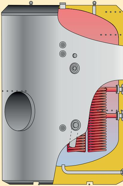
**Aislamiento PU rígido directamente inyectado en el molde**
