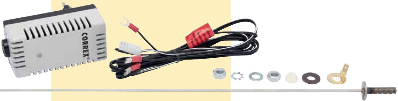
Protección catódica permanente "lapesa correx-up": Equipo de protección catódica permanente que no necesita mantenimiento. Estos ánodos no sufren desgaste y emiten la corriente necesaria de forma automática para la protección catódica del depósito, a través de un potencióstato individual por ánodo, conectado a la red eléctrica.
