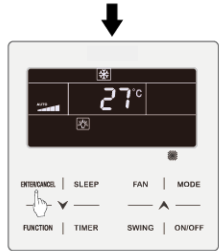
Fig. 4.8: Activación de la función Filter Cleaning Reminding ["Recordatorio de limpieza de filtro"]
