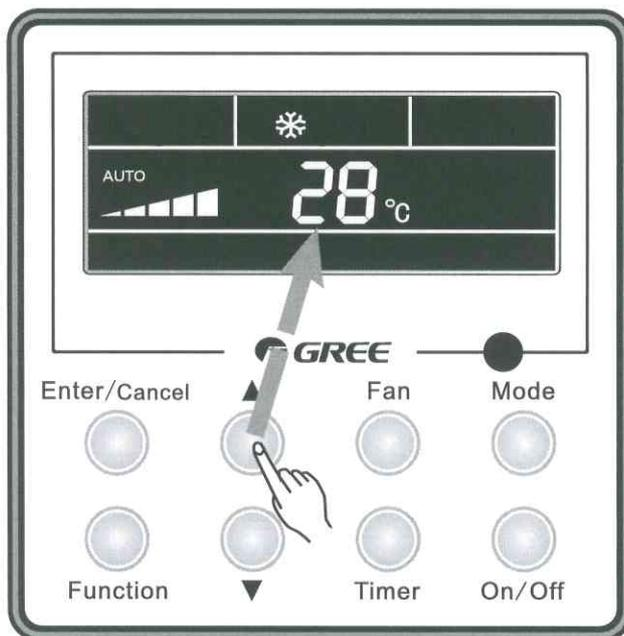
Fig.7 Ajustes de temperatura
